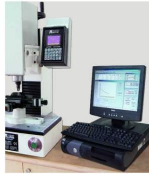
半自动显微硬度测量仪
